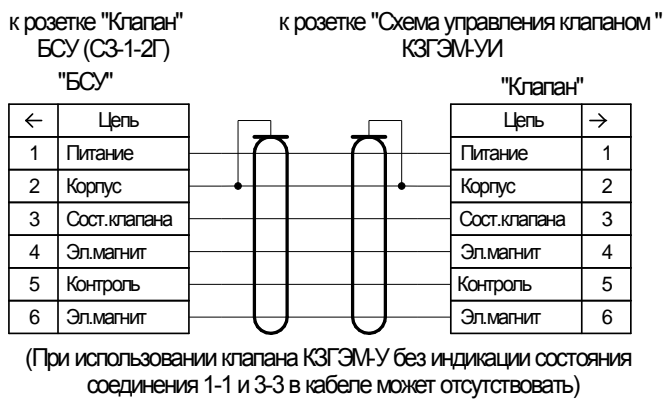
Рисунок Б.3 – Схема кабеля для подключения клапана КЗГЭМ-У
