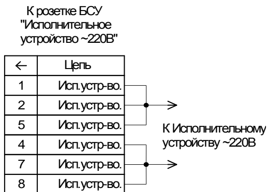
Рисунок Б.5 - Схема распайки вилки подключаемой к разъёму "Исполнительное устройство" БСУ
