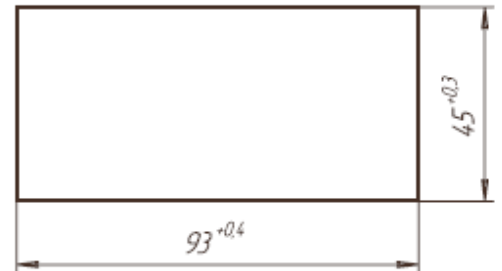
Разметка выреза в щите под крепление регулятора МИНИТЕРМ 300
