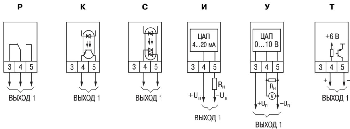
Рис. В.2. Схемы подключения различных модификаций Выходного устройства 1
