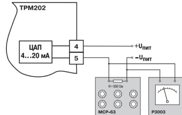
Рис.Е.4. Подключение ВУ1 типа И
