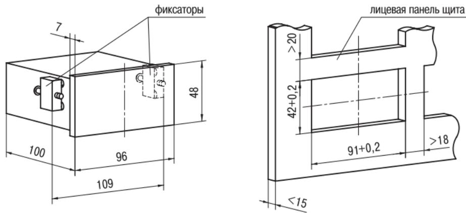
Рис. А.3. Прибор щитового крепления Щ2
