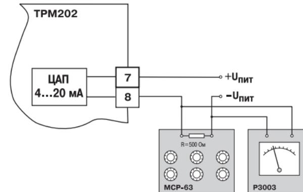
Рис.Е.5. Подключение ВУ2 типа И
