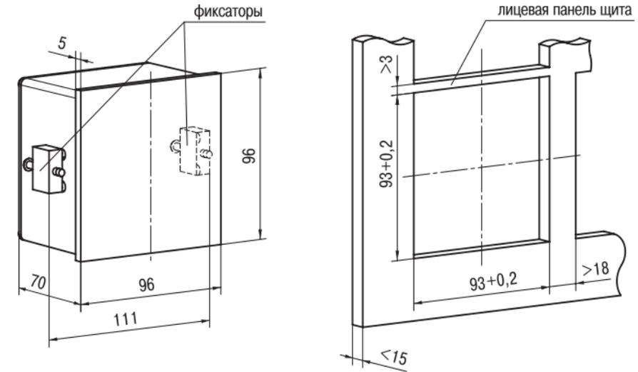
Рис. А.2. Прибор щитового крепления Щ1
