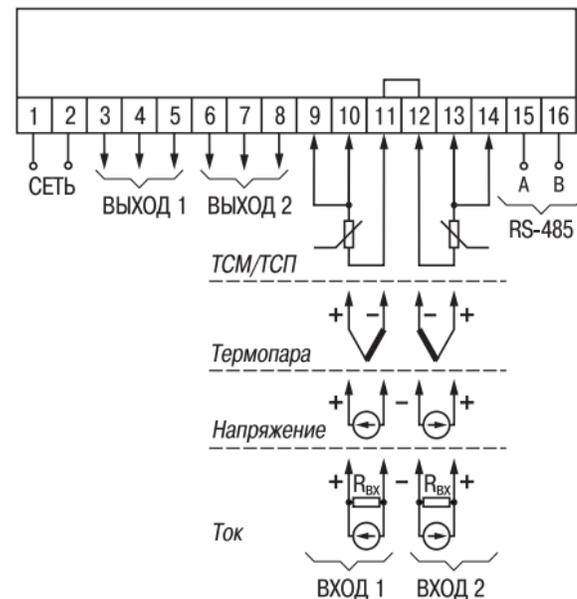
**Рис. В.1. Общая схема подключения TPM202**
