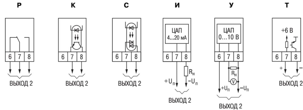
Рис. В.3. Схемы подключения различных модификаций Выходного устройства 2
