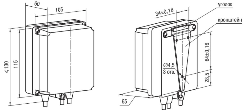
Рис. А.1. Прибор настенного крепления Н
