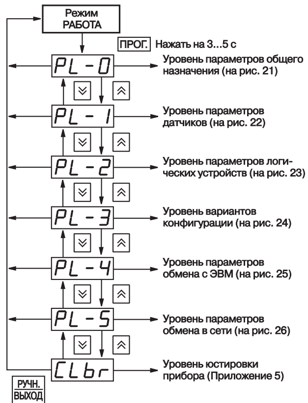
Рис. 19. Схема выбора уровня программируемых параметров
