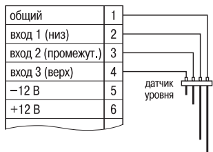
Рис. Б2. Схема подключения кондуктометрических датчиков уровня
