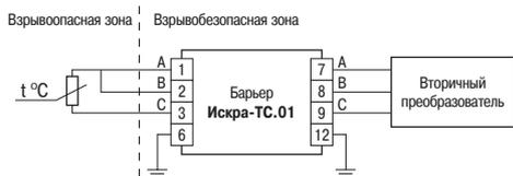
Рис. 3. Схема подключения барьера Искра-ТС.01
